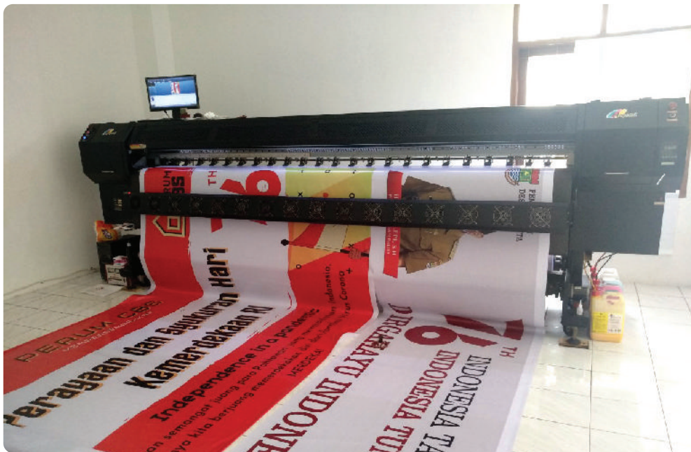
Gambar 3.5 Mesin cetak digital dapat memenuhi kebutuhan cetak sesuai keinginan pasar secara satuan.
